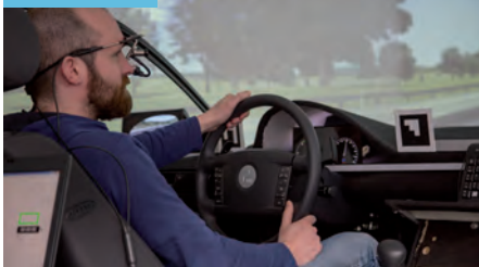
Fahrsimulator zur Erforschung hochautomatisierter Fahrfunktionen, Quelle: OFFIS - Bonnie Bartusch
