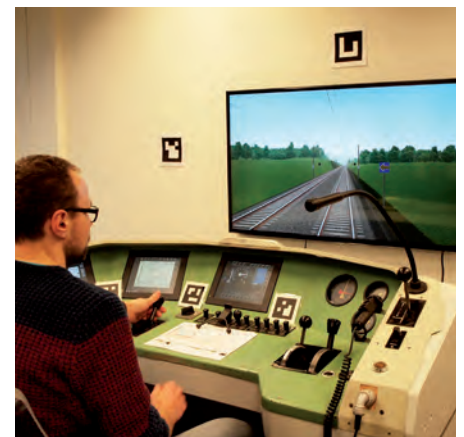
Fahrsimulator während der Fahrt auf einer ETCS-Strecke
