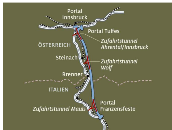
Abbildung 9-6 Verlauf Brenner Basistunnel
